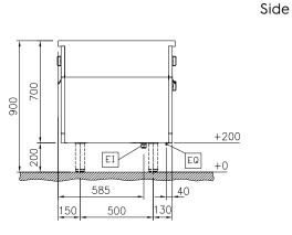
Electrical inlet (power) Equipotential screw
